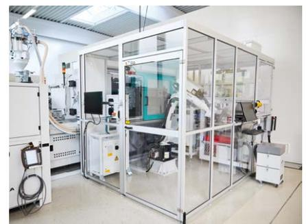
In der Turnkey-Anlage für die Fertigung von Zellfiltern wurde das automatisierte Umspritzen hauchdünner Filtermembrane realisiert.
