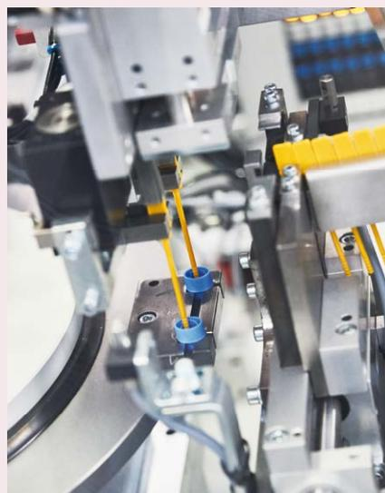
Links: Aus den bei Rittinghaus gespritzten Einzelteilen entstehen per Montageautomat die vormontierten Baugruppen eines Testkit für humane Stuhlproben. In den Devices sind Dichtungs- und Rastfunktionen umgesetzt.
