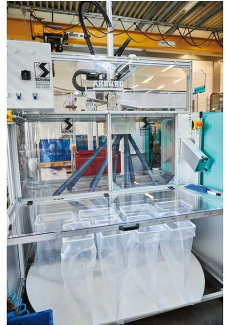
Die inzwischen dritte Turnkey-Anlage mit kavitätengenetzter Separierung der Artikel „Waste Bag Port“ ist seit kurzem im Serienbetrieb.
