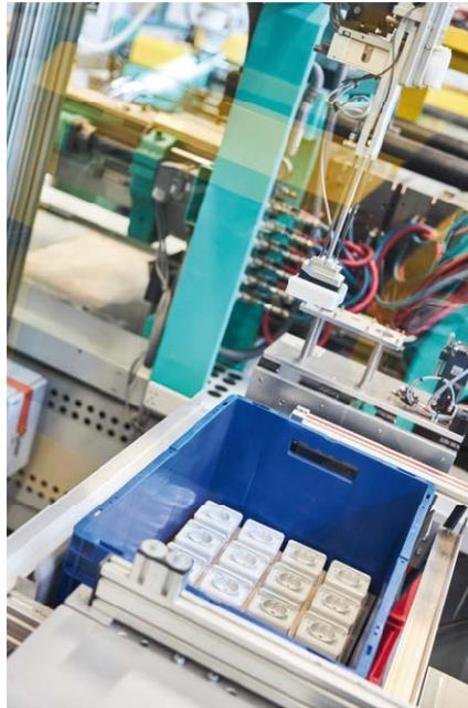
Die Zelle mit elektrischer Spritzgießmaschine zur Produktion von Aufputz-Steckdosen wurde für eine autarke Laufzeit von 15 Stunden konzipiert.
