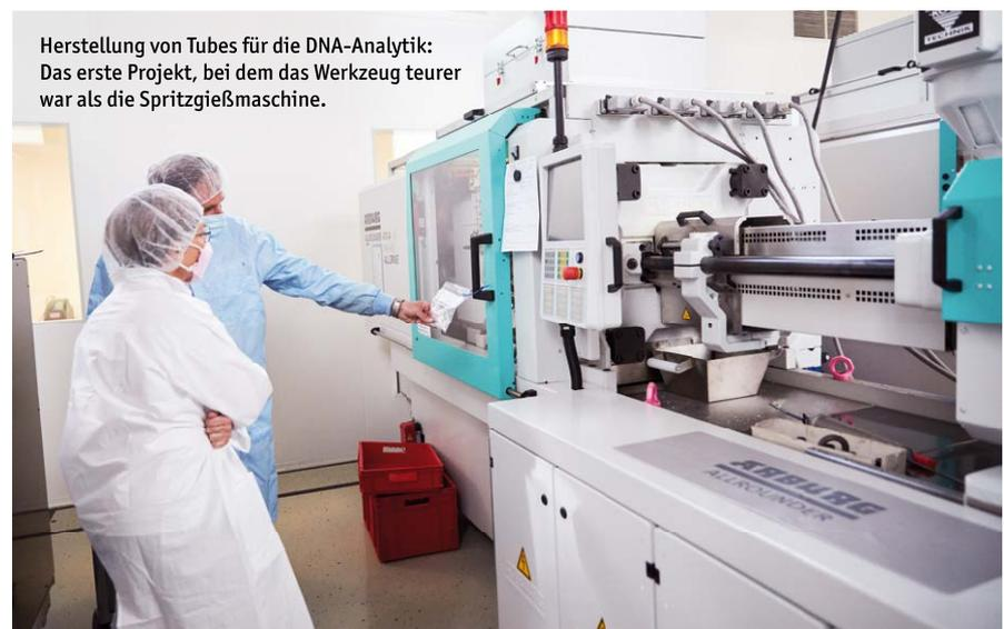
Herstellung von Tubes für die DNA-Analytik: Das erste Projekt, bei dem das Werkzeug teurer war als die Spritzgießmaschine.
