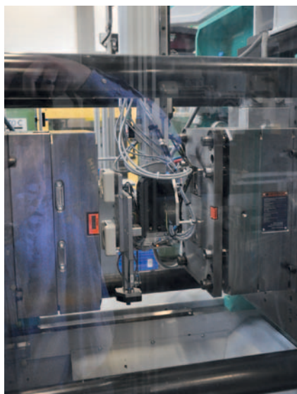
▲ Der Greifer im geöffneten Werkzeug entnimmt die beiden Bauteile.
