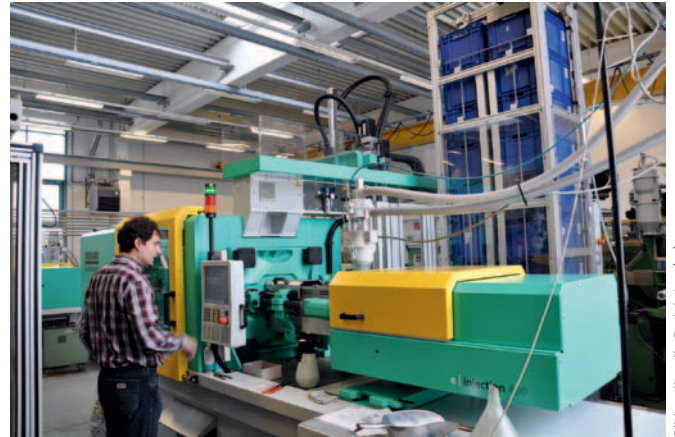
▲ Die automatisierte Fertigungszelle aus Spritzgießmaschine, Entnahmeroboter, Verpackungstechnik und senkrechtem Bunker.
