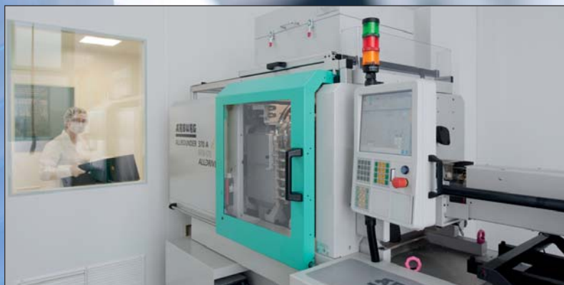
Der elektrische ALLROUNDER 320 A ist an den Reinraum angedockt (links). Das 16-fach-Werkzeug (unten links) zur Herstellung der „Collectingtubes“ (unten rechts) stammt aus dem Werkzeugbau von Rittinghaus.
