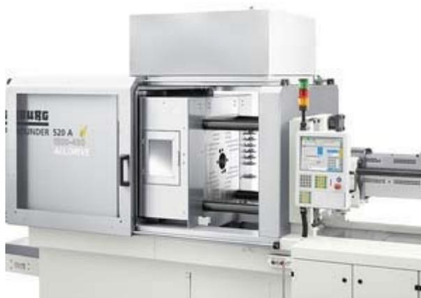
Sauberes Arbeiten garantiert: Der elektrische Allrounder 520 A verfügt u.a. über eine gekapselte Schließeinheit in Edelstahlausführung, vernickelte Aufspannplatten mit abgedeckten Bohrungen und ein Reinraummodul
